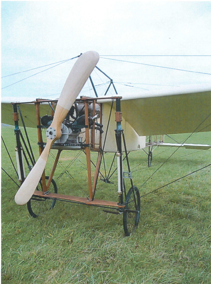
Reconstitution d'un aéroplane Louis Blériot Type XI Traversée de la Manche monoplan motorisé, hélice bipale, 233 kg.
